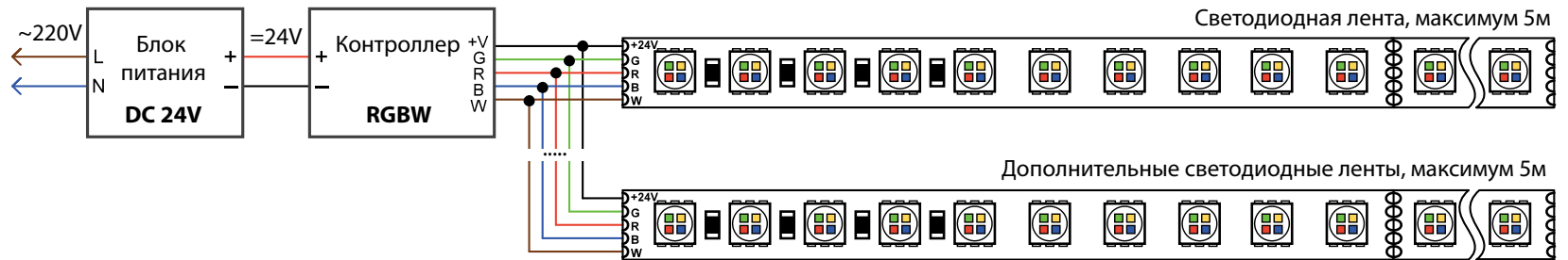
Рис. 1 Подключение светодиодной ленты RGBW-One к контроллеру. Одинаковый ток на каждом канале.
